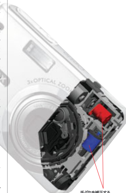
手ぶれを補正する 2つのステップモーター
