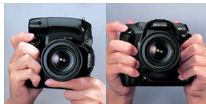
縦位置撮影:右手でバッテリーグリップを、左手でボディのウイングを保持。
