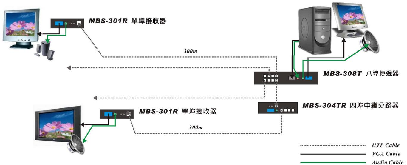
基本型 多媒體影音 UTP 延伸器 系統連接示意圖
