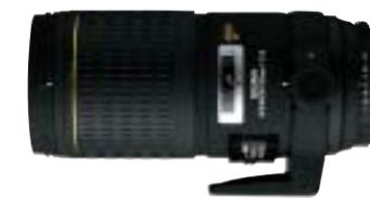
等倍撮影が可能な望遠マクロレンズ。フローティングインナーフォーカス、SLD(特殊低分散)ガラスを採用し、全撮影領域で高い光学性能を発揮。HSM搭載機種では、フルタイムマニュアルフォーカスが可能。別売りのアポテレコンバーターを装着すると、1.4xでは252mm AFとして使用可能、1.2mより近い撮影時には自動的にMFに切替わります(ミノルタ、ペンタックス用はMF対応のみ)。2xは360mm MFとして使用できます。
