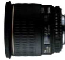
最大撮影倍率1:2.7。フローティングフォーカスの採用により、最短撮影距離18cmを実現した大口徑広角レンズ。ビネッティングが少なく、周辺光量は十分です。非球面レンズを2枚採用し、各収差とディストーションを良好に補正。フォーカスは直進式で、花形フードを標準装備。
