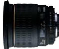
大口徑F1.8の明るさを備えた、画角94.5°の20mm超広角レンズ。近接撮影が楽しめ、最短撮影距離20cm、ワーキングディスタンスは6.5cmを実現しました。非球面レンズの採用で、ディストーションをはじめ、球面収差、非点収差を良好に補正。ビネッティングが少なく、周辺光量は十分です。リアフォーカスの採用で前玉が回転せず、花形フードの装着が可能です。
