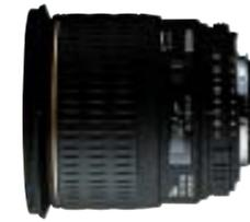
最大撮影倍率1:2.9を実現した、大口徑広角レンズ。フローティングフォーカスの採用により、最短撮影距離20cmでの近接撮影を可能にしました。ビネッティングが少なく、周辺光量は十分です。非球面レンズの採用で、ディストーションをはじめ各収差を良好に補正。フォーカスは直進式で、花形フードを標準装備。
