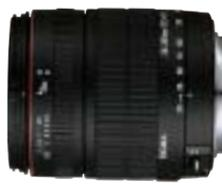
全長86mm、最大径74mm、フィルターサイズ62mmのコンパクト化を達成した高倍率ズーム。最短撮影距離はズーム全域で50cm、望遠300mm側では最大撮影倍率1:3のマクロ撮影が可能。1本のレンズで広角・望遠・接写まで、被写体の多様な変化に対応。SLD(特殊低分散)ガラス2枚、非球面レンズ4枚を採用し、諸収差を良好に補正。レンズの自重落下を防ぐズームロック機構を搭載。
