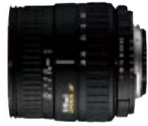
幅広い領域をカバーする新標準ズーム。非球面レンズの採用により、全域で歪曲収差を良好に補正しました。シグマ独自のダブルカム内焦式ズームシステムを採用することにより、ズーム全域で最短撮影距離50cmが可能です。小型・軽量化で、すぐれた描写力と高い操作性を備えた1本。フロント部が回転しないので、遮光効果にすぐれた花形フードの装着が可能。円偏光フィルターの使用も容易です。
