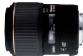
高い描写性能を備えた中望遠マクロ。デジタル一眼レフカメラにも最適な性能を発揮。レンズのパワー配置やレンズ構成の見直し、最先端コーティング技術の活用などにより、ゴーストやフレアーの根本原因を排除、イメージャーからの反射による有害光の発生も低減しています。ねじ込みフードの採用で円偏光フィルターの使用も容易。被写界深度の深いF45の絞りも備えています(ニコン、ペンタックス用はF32)。
