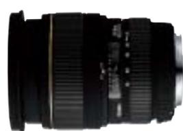
開放値F2.8を実現した、24mmから始まる大口径ズームレンズ。非球面レンズとSLD(特殊低分散)ガラスを採用し、各収差を良好に補正、高画質を達成しています。最短撮影距離はズーム全域で40cm、最大撮影倍率は1:3.8のマクロ撮影も可能です。フォーカシング時にフロント部が回転しないので、遮光効果にすぐれた花形フードの装着が可能です。
