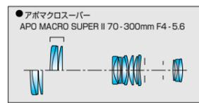
の性能を維持しながらマクロレンズなみに接写ができるズームマクロを開発しました。着脱の面倒な接写用アクセサリを用いることなく、望遠側で1:2の撮影倍率を実現、通常の撮影領域から本格的なマクロ撮影領域へ、瞬時に入っていくことができます。
